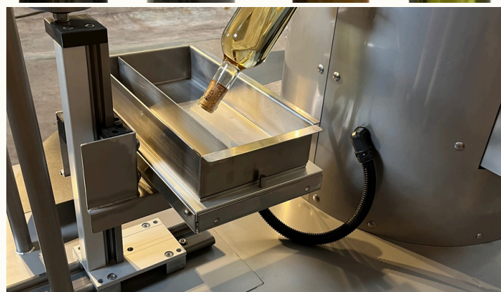
Réglage de la hauteur de cire et cirage en V
