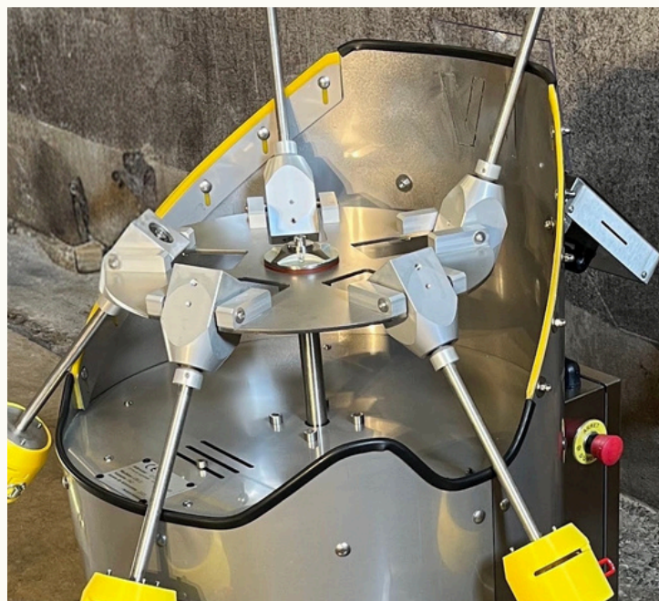
Rampe de plongée et d'égouttage
