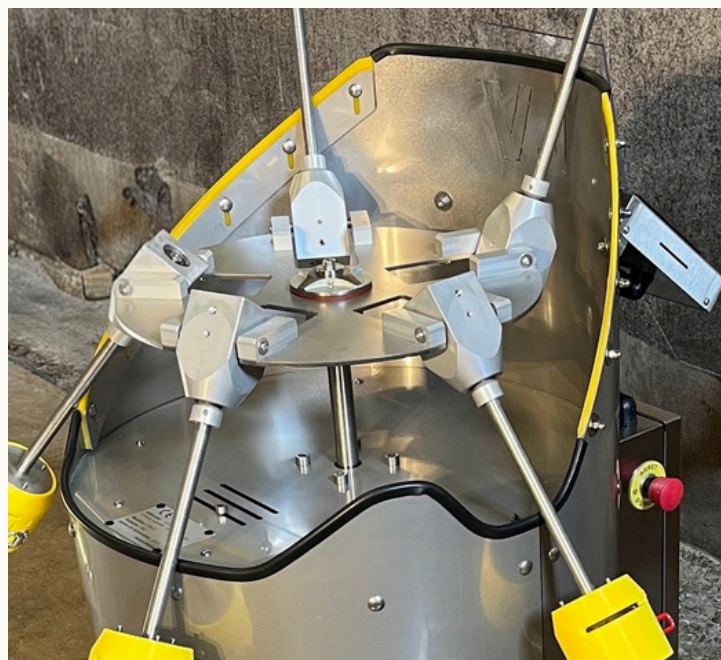
Rampe de plongée et d'égouttage (CIR-22)
